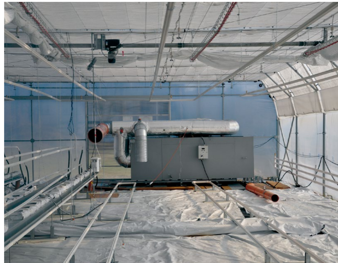
Stanowisko laboratoryjne – tunel foliowy z akumulatorem kamiennym i akumulatorem przemiany fazowej. Uprawa możliwa w okresie IV-IX.
