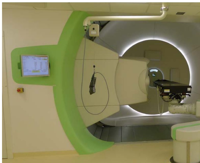
Stanowisko terapeutyczne gantry do napromieniania skanującą wiązką protonów. Jedno z najbardziej zaawansowanych na świecie.
