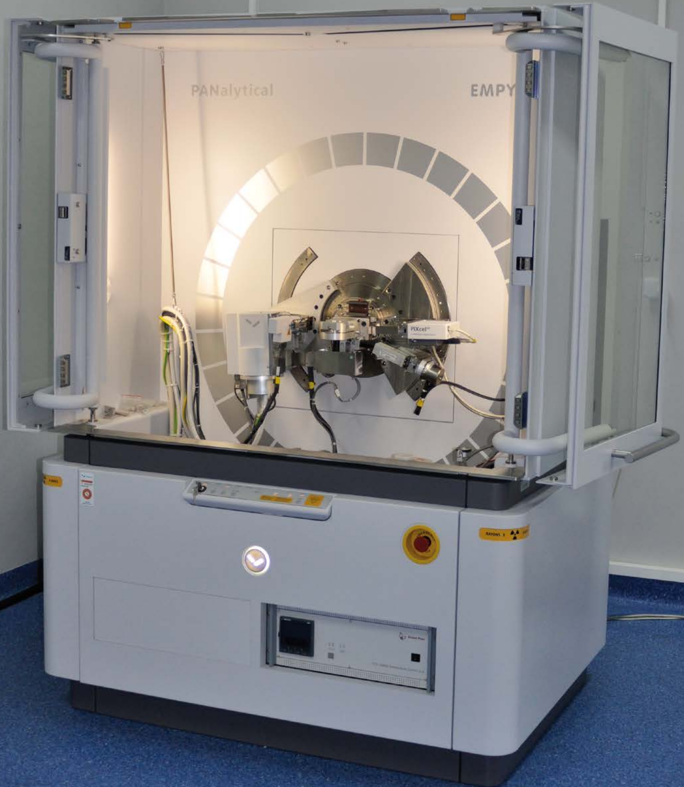
Laboratorium SINTERCER - Dyfraktometr rentgenowski Empyrean (PANalytical)
